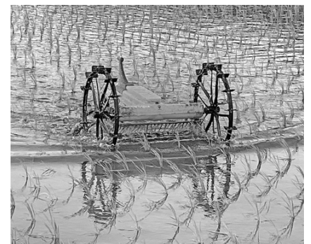
除草剤散布に代わる除草機実証実験
