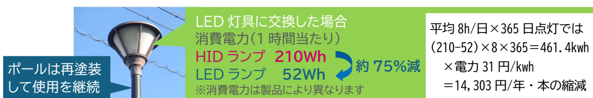
図 4-6 灯具のLED化によるコスト縮減のイメージ
